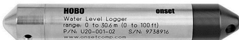
Рис. 4. HOBO U20-001-02 Регистраторы уровня и температуры воды будут установлены в каждом из 5 основных озер ледника Баралмас
